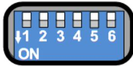
Рисунок 4.2 – Переключатели на задней панели анализатора (все выключены)
