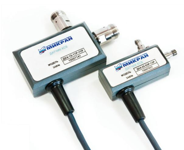
Датчики КСВ серии ДК1, ДК4 используются в анализаторах P2M для выделения электромагнитной волны, отраженной от порта исследуемого устройства при измерении модуля коэффициента отражения и КСВН.
