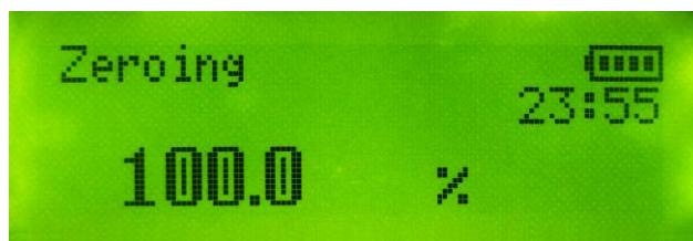
Figure 2.3.1 – Indicator status «Zeroing»
