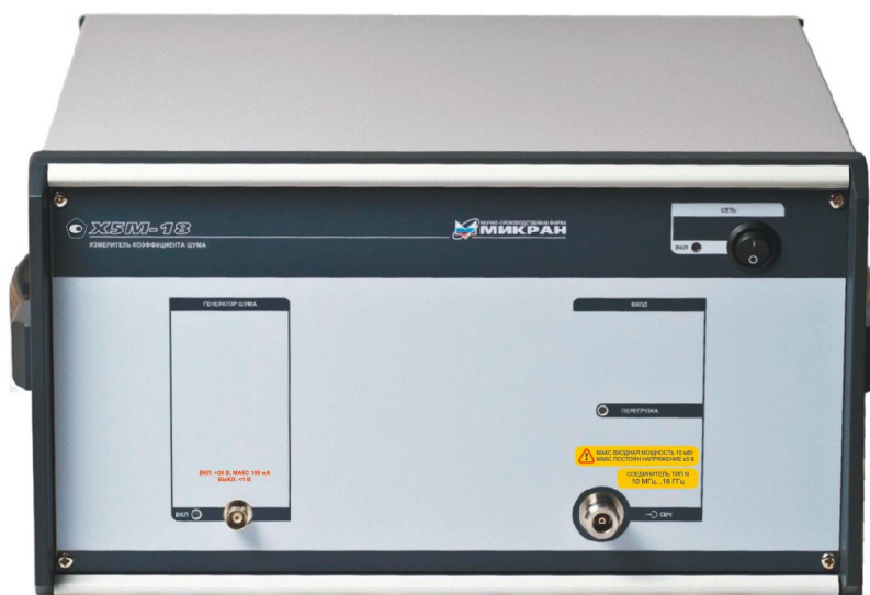
Рисунок 4.1.1 – Внешний вид измерителей коэффициента шума X5M-18/1 (передняя панель)
